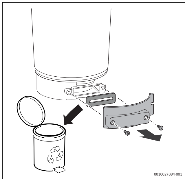
Sl.130 Odpiranje kontrolne odprtine
