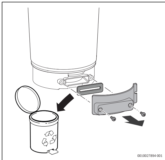
Sl.130 Odpiranje kontrolne odprtine
